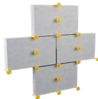
Schema di fissaggio tramite tassellatura
