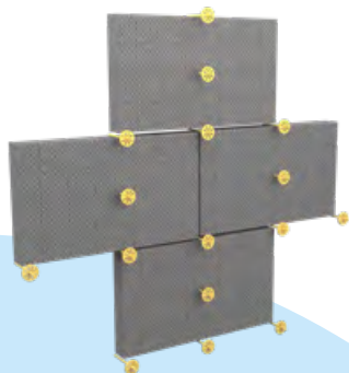
Schema di fissaggio tramite tassellatura
