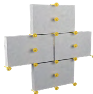
Schema di fissaggio tramite tassellatura
