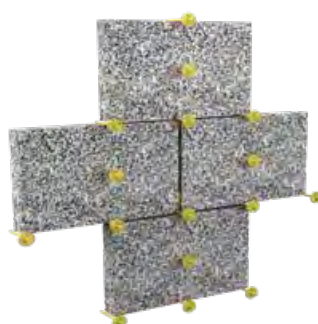
Schema di fissaggio tramite tassellatura
