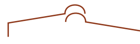
Particolare in sezione di 2 semicolmi che formano la linea di colmo per il tetto a doppia falda.
